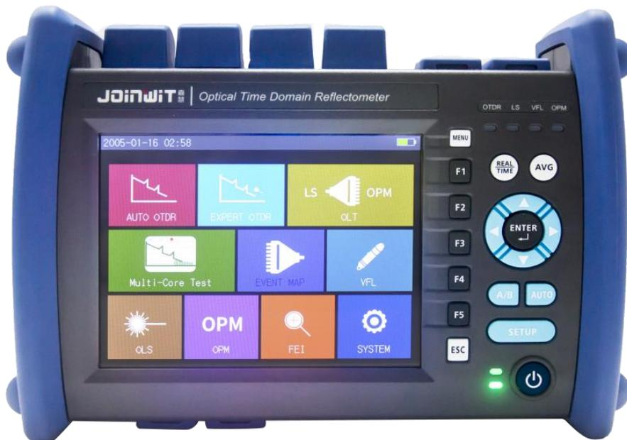
Оптический рефлектометр **JW3302E** это универсальный оптический рефлектометр для контроля одномодовых линий связи на длинах волн 1310/1550 нм и предназначен для измерения ослабления и отражения оптического сигнала, длины волокна до мест неоднородностей.
