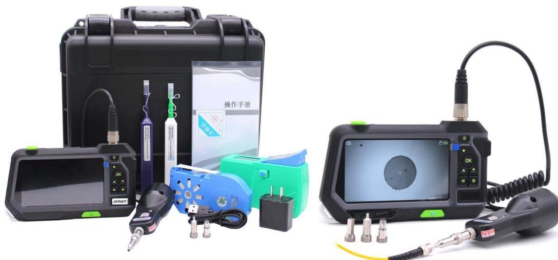
Волоконно-оптический видеоскоп **JW5009N** предназначен для проверки торцевой поверхности разъёма перед его подключением. Это важнейший этап при выходном контроле, построении оптоволоконной сети и при измерениях на такой сети, поскольку загрязнённые и повреждённые поверхности разъёмов приводят к ошибкам измерений, повреждению разъёмов измерительных приборов, снижают качество передачи вплоть до отказов.
