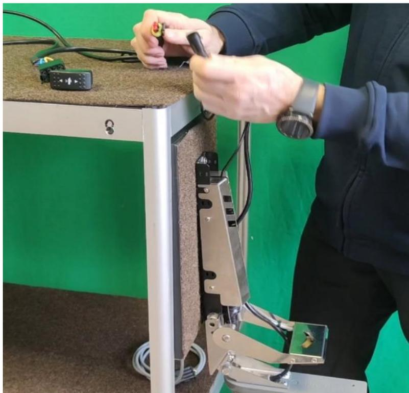
и отключаем кнопку ручного управления от провода, идущего к регулятору и от провода питания.
