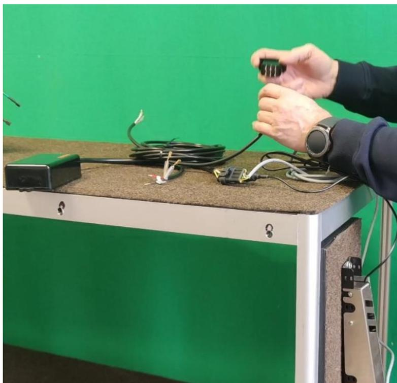
9. Подключаем автоматический блок к питанию (бортовая сеть) в соответствии с маркировкой проводов (+ и -).
